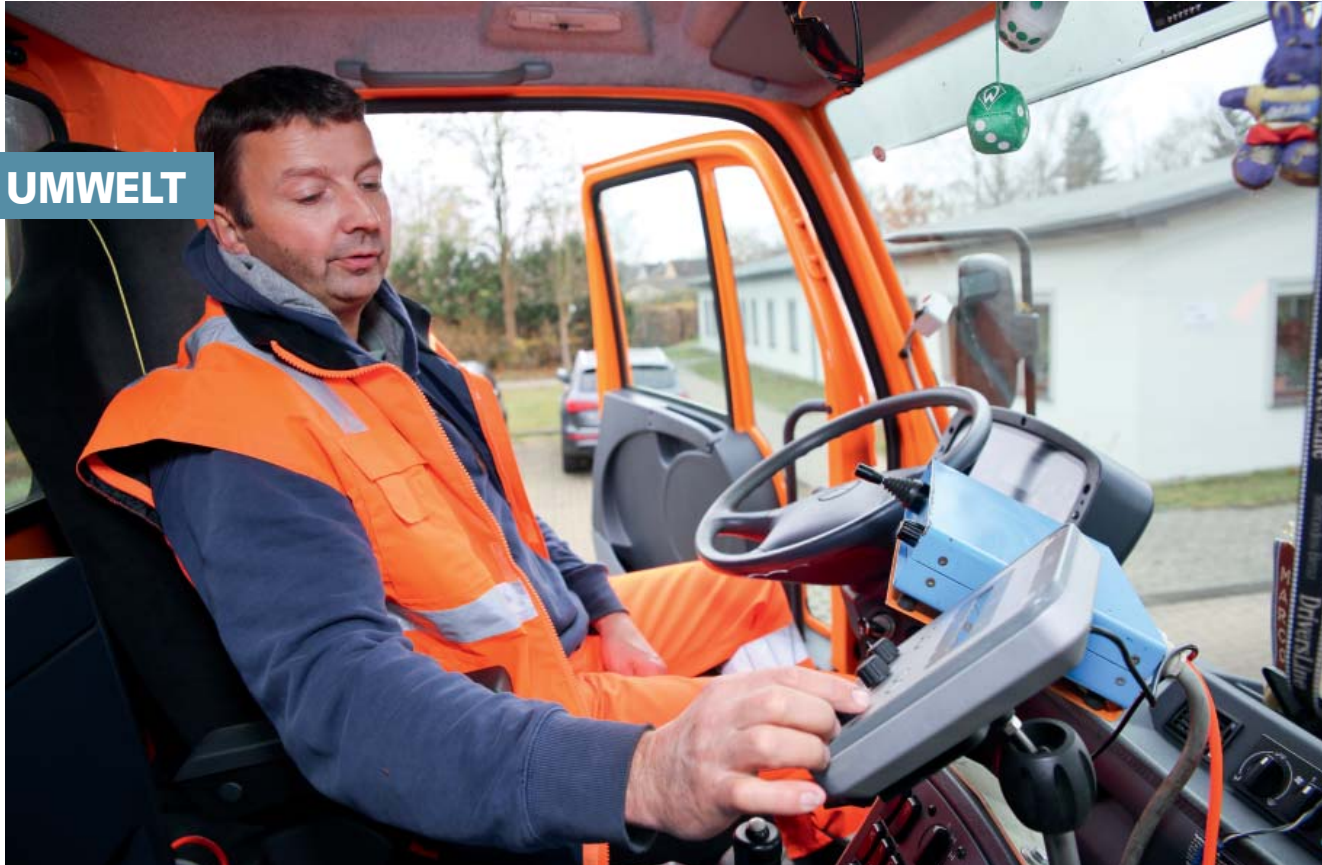
StadtService-Mitarbeiter Marko Bohne dosiert über den Bordcomputer die Salzzufuhr.
