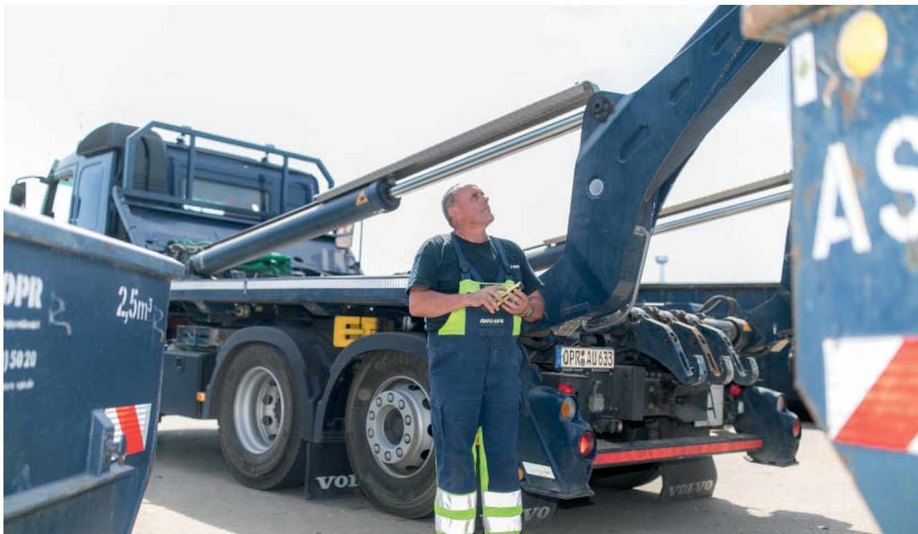
Burkhardt Domke steuert den Ladevorgang zentimetergenau per Fernbedienung.
